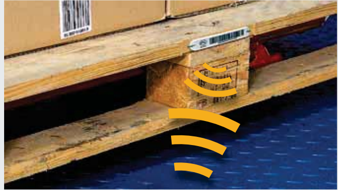
RFID transponder ve okuma cihazı arasındaki en kısa yoldan güvenilir veri aktarımı.
